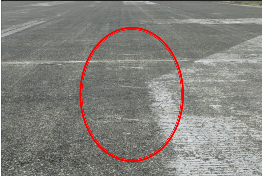
Fotografía No. 2 - Huellas dejadas por las palas de las hélices al golpear la pista.
